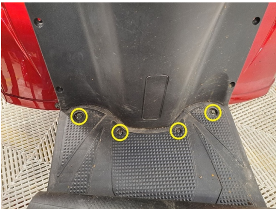
Irrota etukatteen sisäosan alhaalta kaksi kiinnityspulttia (hylsy 8 mm) ja kaksi kiinnitysruvia. (ristipäämeisseli ph2).
