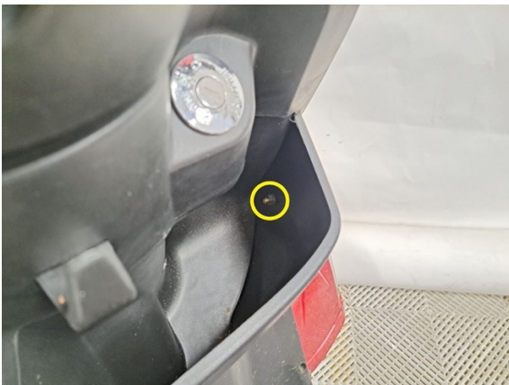
Irrota oikean puolen sivuheijastimen kiinnitysmutteri. (hylsy 10 mm).
