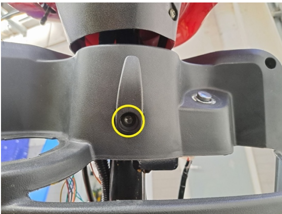
Irrota kassikoukun kiinnityspultti. (hylsy 8 mm).
